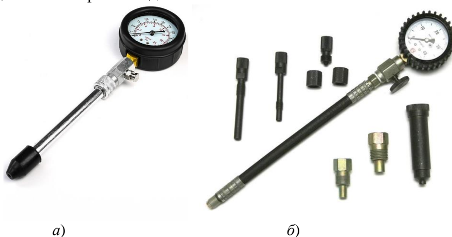
Рис. 3.3. Компрессометры: а – для бензиновых двигателей; б – для дизельных двигателей
