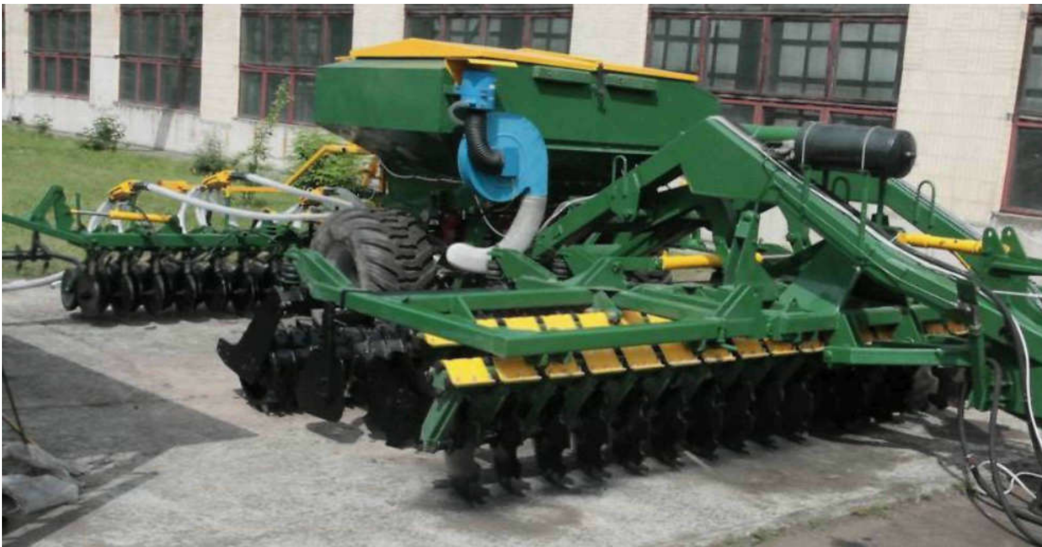
Агрегат почвообрабатывающий посевной АППА-6-03 с пассивными дисковыми рабочими органами для работы на легких и средних почвах в системах отвального и безотвального земледелия
