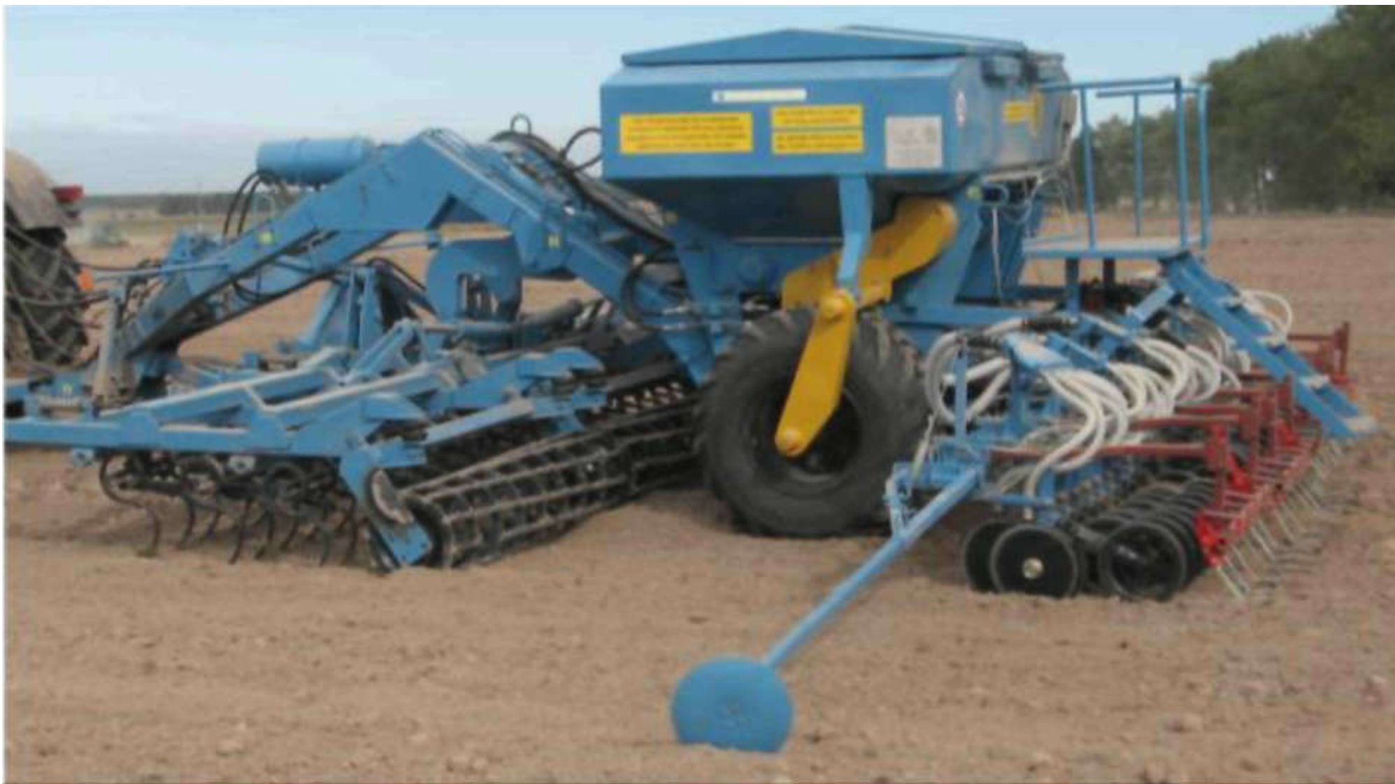
Агрегат почвообрабатывающий посевной АППА-6-01 с пассивными лаповыми рабочими органами для работы на легких и средних почвах в системе отвального земледелия
