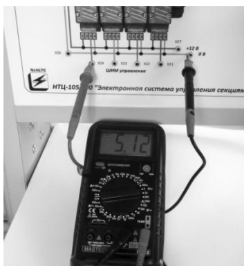
Рис. 9.14. Измерение напряжения: а – мультиметром; б – осциллографом
