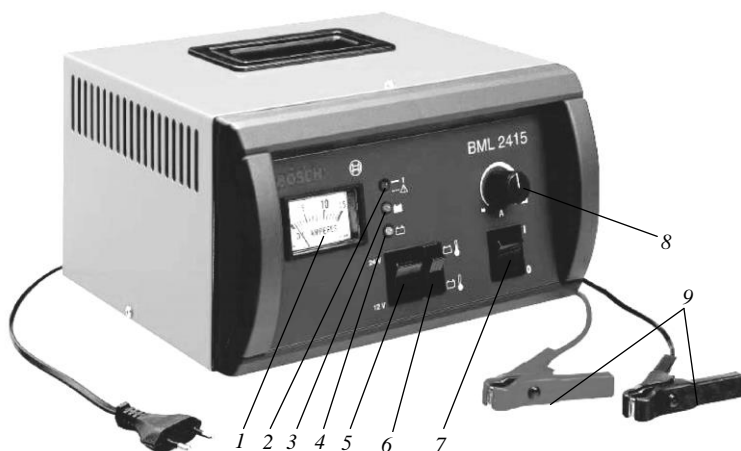
Рис. 7.8. Зарядное устройство Bosch BML 2415: 1 – индикатор силы зарядного тока; 2 – индикатор включения; 3 – индикатор достижения максимального напряжения зарядки; 4 – индикатор зарядки; 5 – переключатель номинального напряжения батареи; 6 – переключатель температуры батареи; 7 – главный выключатель; 8 – регулятор силы зарядного тока; 9 – зарядный кабель с цапгами
