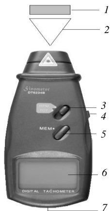
Рис. 7.13. Фототахометр DT6234B: 1 – отражающая метка; 2 – световой луч; 3 – кнопка «Измерение»; 4 – переключатель режима; 5 – кнопка «МЕМ»; 6 – дисплей; 7 – крышка отсека батареи
