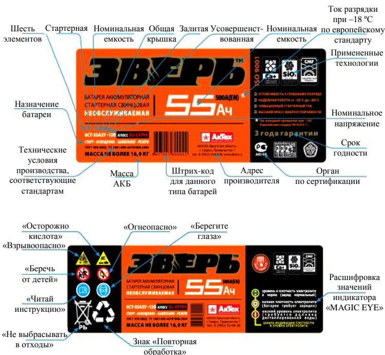
Рис. 7.1. Пример маркировки аккумуляторной батареи
