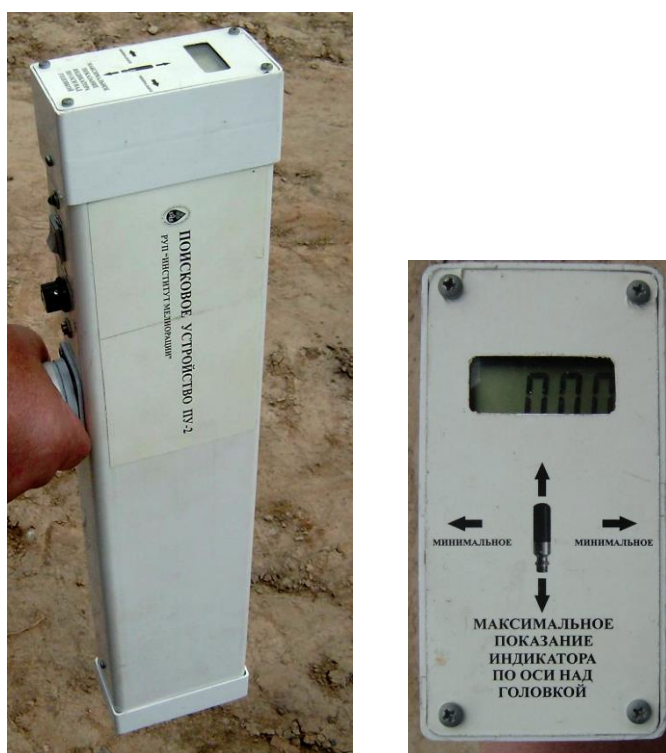
Рис. 21. Поисковый комплект трасс дренажных коллекторов ПУ-2.
