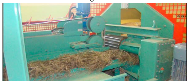
Рис. 60. Линия по производству длинного волокна: а – общий вид; б – загрузка рулонов на линию; в – формирование слоя; г – мяльная машина; д – длинное волокно
