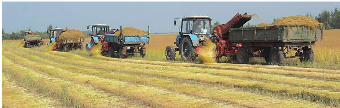
Рис. 58. Уборка (теребление) льна с очесыванием семенных коробочек и расстилом соломы в ленты
