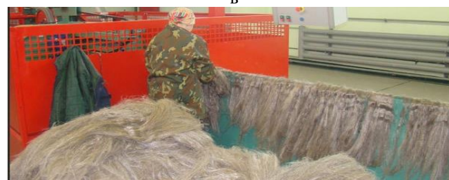
Рис. 60. Линия по производству длинного волокна: а – общий вид; б – загрузка рулонов на линию; в – формирование слоя; г – мяльная машина; д – длинное волокно
