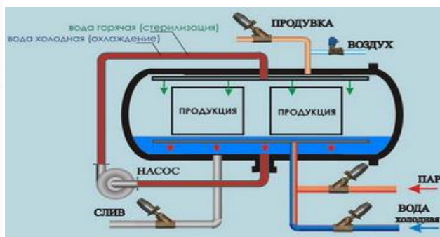
Рис. 41. Стерилизация продукции в автоклаве
