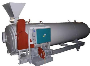
Рис. 40. Барабанный и ковшовый бланширователи
