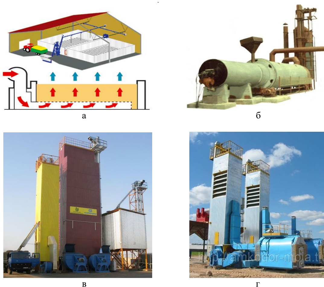
Рис. 10. Типы зерносушилок: а – напольная, б – барабанная, в – шахтная, г – колонковая
