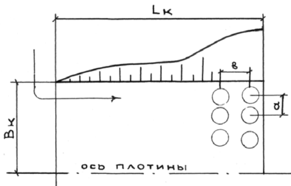
Рис. 12. Схема отсыпки грунта на карте укладки (стрелкой обозначено направление движения транспортного средства)
