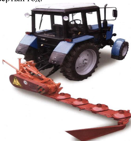
Рис. 11.5. Косилка роторная АС-1 для окашивания берм.
