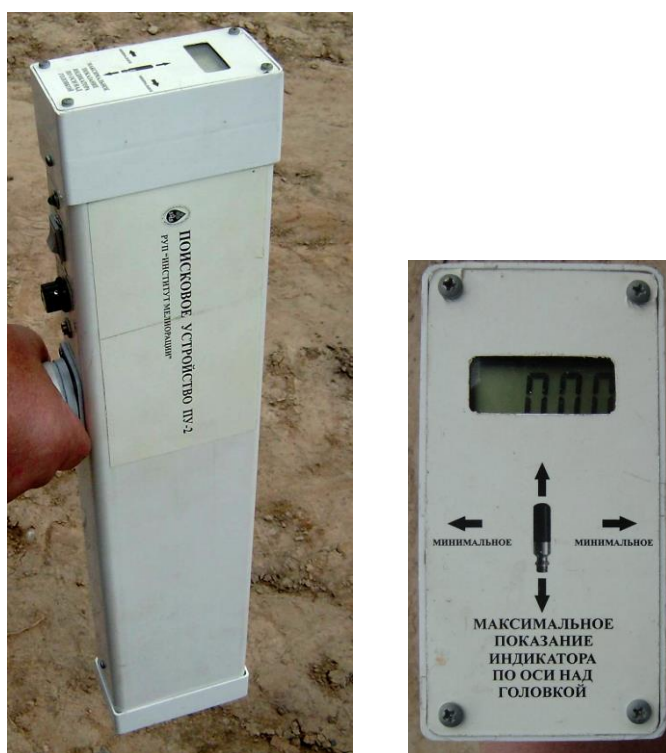
Рис. 11.19. Поисковый комплект трасс дренажных коллекторов ПУ-2.
