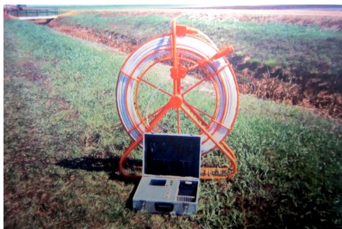
Рис. 11.15. Комплекс средств диагностики внутреннего состояния закрытого дренажа КСД-160.
