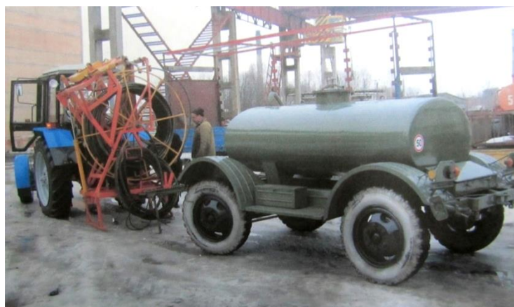
Рис. 11.18. Дренопромывочная машина УПД-120.
