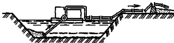
Рис. 11.13. Удаление наносов плавучей землесосной установкой.
