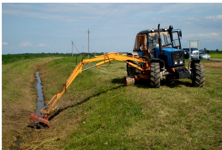
Рис. 11.12. Каналоочиститель с однороторным рабочим органом.
