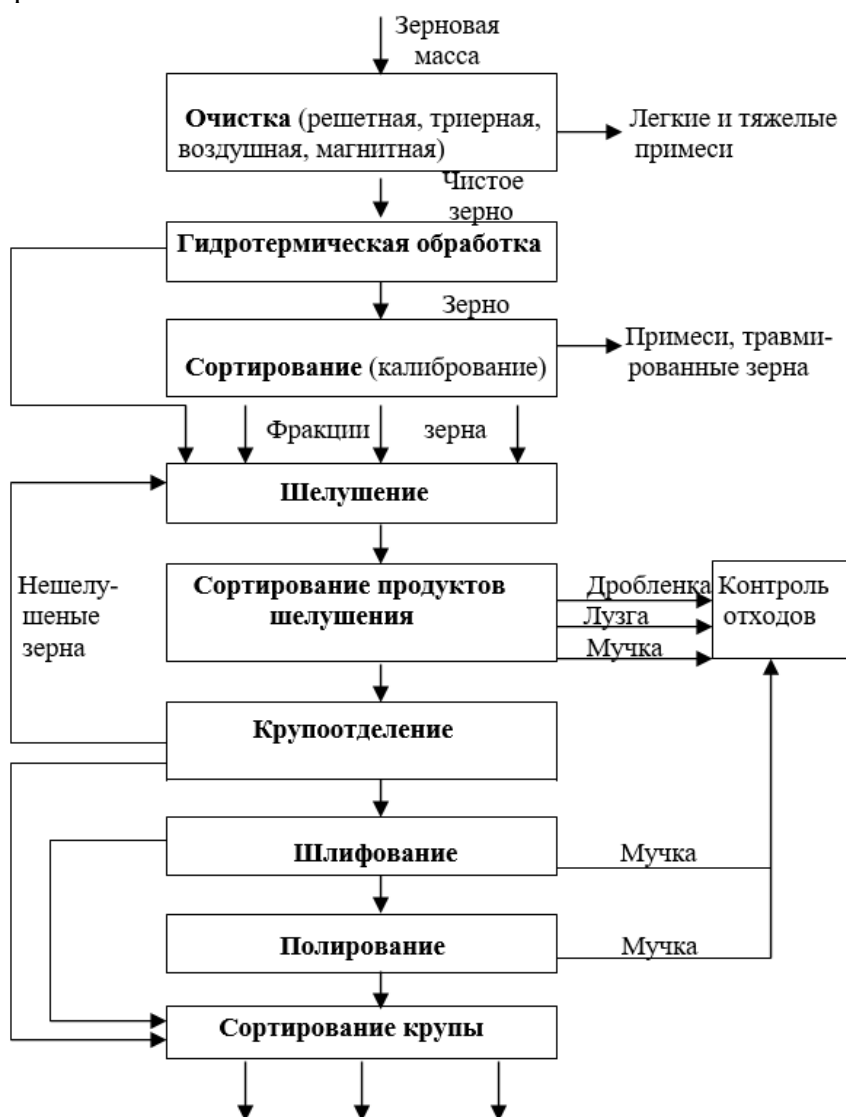
Рис. 13. Технологическая схема переработки зерна в крупу
