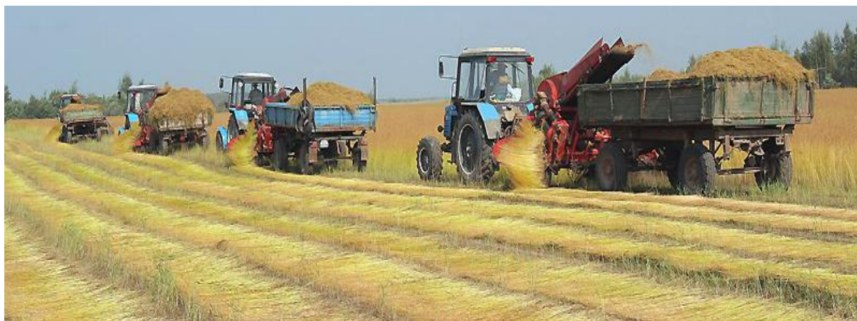
Рис. 51. Уборка (теребление) льна с очесыванием семенных коробочек и расстилом соломы в ленты
