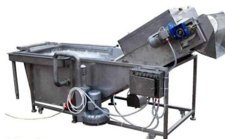
Рис. 31. Моечная машина КУМ-1: 1 – люк; 2 – редуктор; 3 – душевая установка; 4 – ванна; 5 – воздушный компрессор
