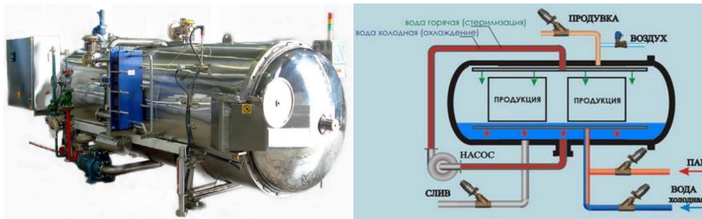
Рис.40. Стерилизация продукции в автоклаве
