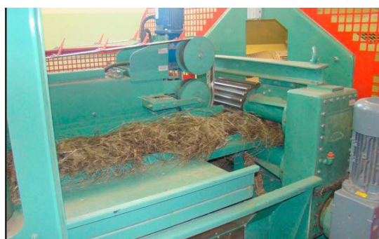
Рис. 50. Линия по производству длинного волокна: а – общий вид; б – загрузка рулонов на линию; в – формирование слоя; г – мяльная машина; д – длинное волокно
