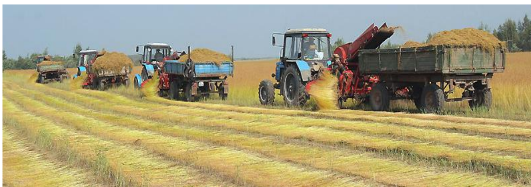
Рис. 49. Уборка (теребление) льна с очесыванием семенных коробочек и расстилом соломы в ленты
