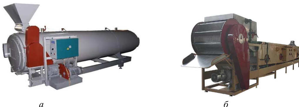
Рис. 38. Барабанный (а) и ковшовый (б) бланширователи
