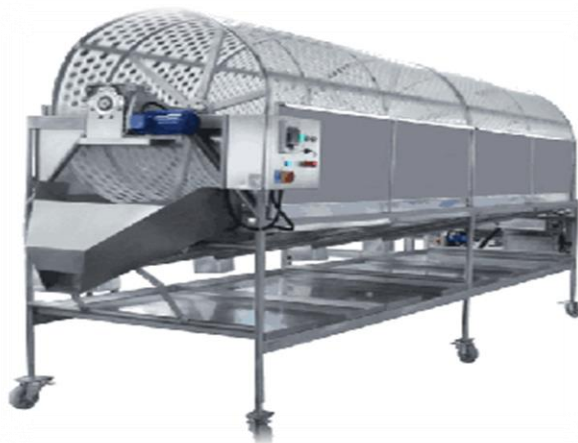
Рис. 33. Барабанная сортировочная машина
