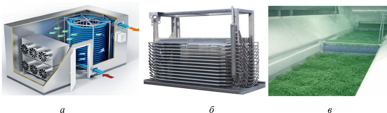
Рис. 40. Морозильные аппараты: а – конвейерный спиральный; б – многоплиточный; в – флюидизационный
