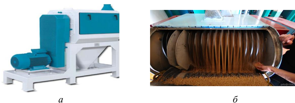
Рис. 10. Оборудование для очистки поверхности зерна: а – обоечная машина; б – щеточная машина
