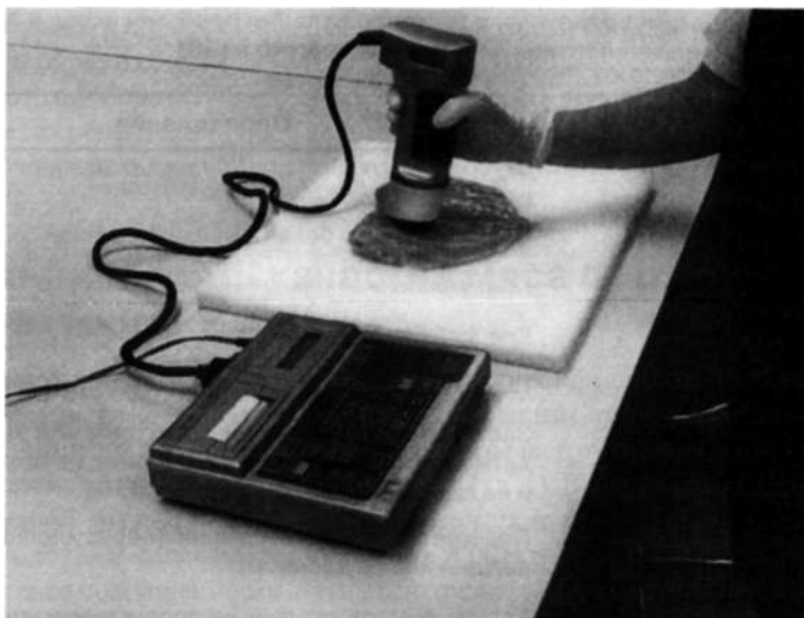
Рис. 7.10. Применение колориметра для определения численных цветовых характеристик филе грудки бройлера
