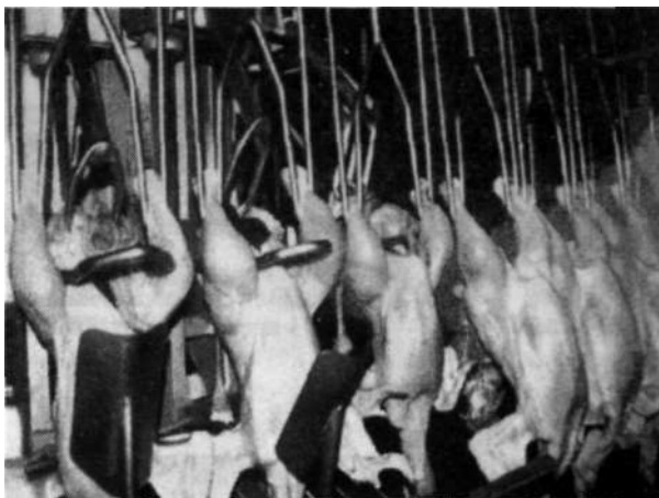
Рис. 3.11. Машина для потрошения или волочилная машина. Виден скребок, извлекающий внутренности из птицы. «Комплект» внутренностей виден за четвертой тушкой слева
