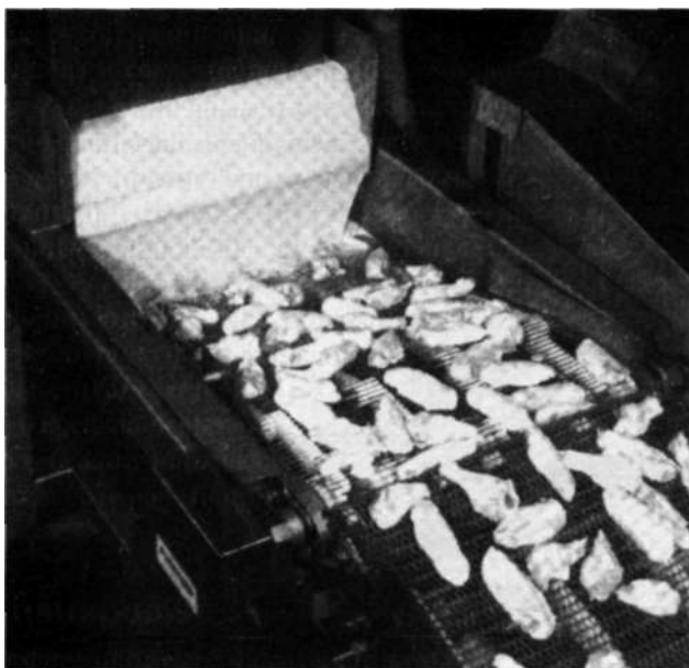
Рис. 13.13. Нанесение жидкой панировки на крылья цыплят каскадным методом (с разрешения STEIN DSI, корпорация FMC FoodTech, Sandusky, OH)
