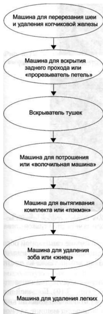
Рис. 3.7. Типичная последовательность расположения и названия оборудования для потрошения
