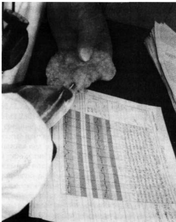
Рис 18.2. Сотрудник отдела контроля качества проверяет температуру продукта после термообработки и вносит данные в карту контроля с цветными полями шкалы X и Y
