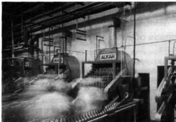
Рис. 15.16. Система ALKAR непрерывного действия для варки и охлаждения пищевых продуктов при поточном производстве сосисок, включая (с разрешения ALKAR, подразделение A, DEC International, Inc., г. Лоди, штат Висконсин)
