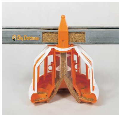
Рис. 4. Поперечный разрез кормушки фирмы Big Dutchman
