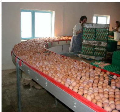
Рис. 11. Прутковые конвейеры для транспортировки яиц
