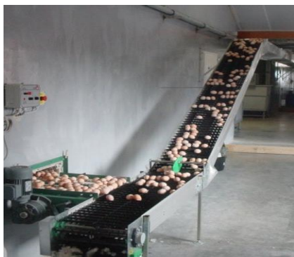
Рис. 11. Прутковые конвейеры для транспортировки яиц
