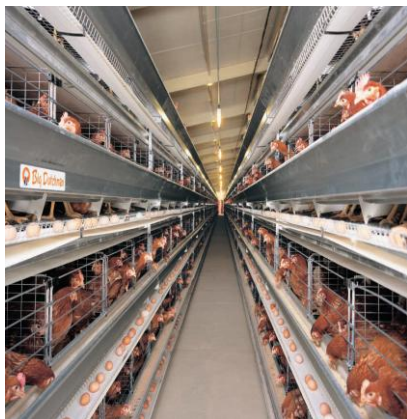
Рис. 3. Клеточная батарея «Унивент» для кур-несушек фирмы Big Dutchman
