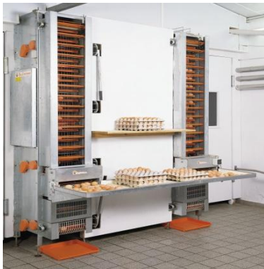
Рис. 8. Этажерочная система сбора яиц
