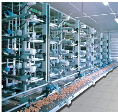
Рис. 10. Лифтовая система сбора яиц «Анаконда»
