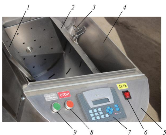
Рис. 15. Общий вид размораживателя молозива РМ-45 с вращающимся барабаном: 1 – дверца; 2 – барабан; 3 – защелка; 4 – ванна; 5 – панель пульта управления; 6 – выключатель «Сеть»; 7 – контроллер; 8 – кнопка «Стоп»; 9 – кнопка «Доворот барабана»
