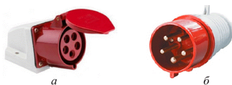
Рис. 35. Силовой электрический разъем типа 3Р+РЕ+N: а – розетка стационарная; б – вилка переносная
