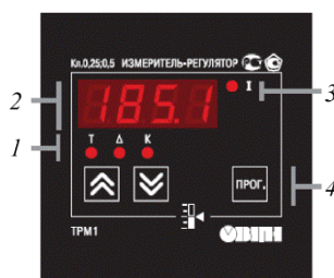
Рис. 8. Панель управления терморегулятора: 1 – индикаторы редактируемых параметров; 2 – цифровой индикатор; 3 – индикатор текущего состояния терморегулятора; 4 – кнопки управления
