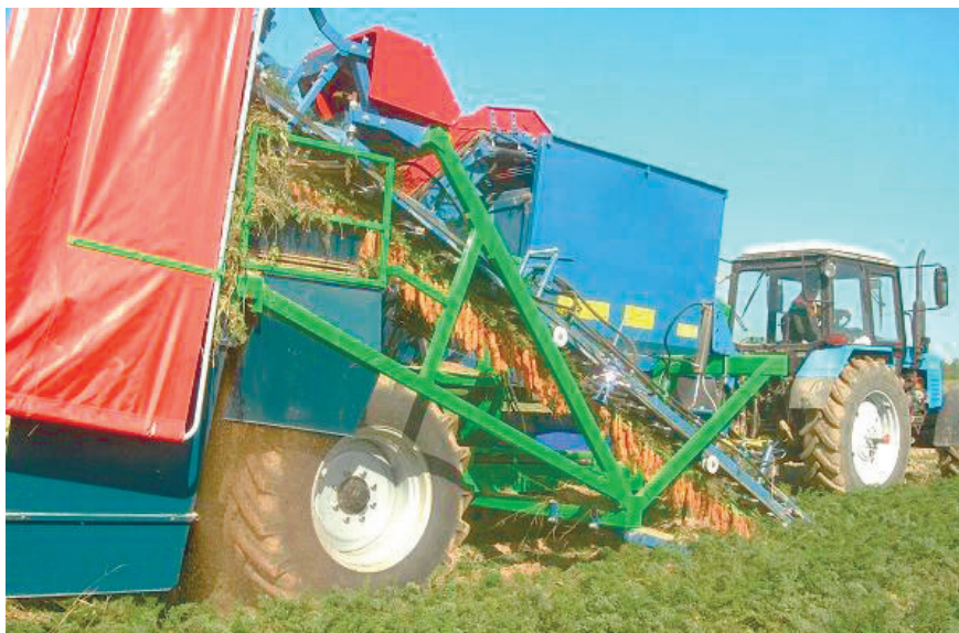
Рис. 10.3. Однорядный комбайн для уборки моркови
