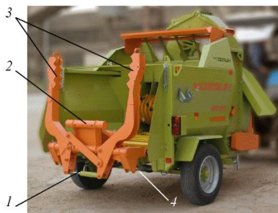
Рис. 3. Общий вид раздатчика-выдувателя с манипулятором вилочного типа: 1, 4 – гидrocилиндры; 2 – направляющая; 3 – рычаги
