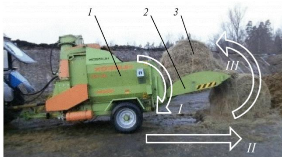
Рис. 2. Последовательность самозагрузки рулона в раздатчик-выдуватель:
