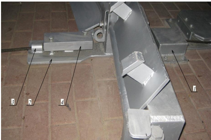
Рис. 4. Механизм управления скрепером: 1 – упор; 2 – лыжа; 3 – направляющая втулка; 4 – крышка
