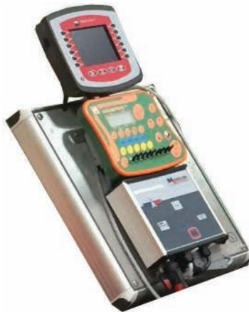
Рисунок 5.1 – Демонстрационный стенд для управления секциями опрыскивателя
