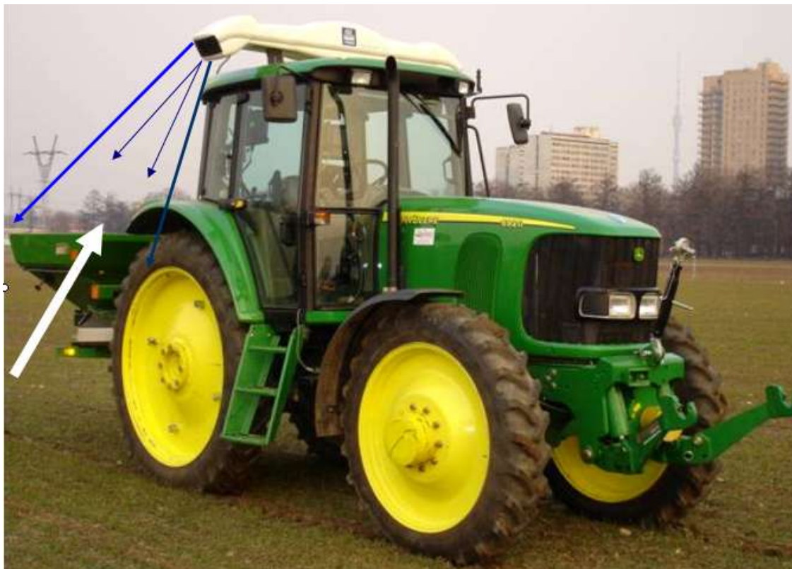
Рис. 43. Работа системы N-Sensor ® ALS с машиной для внесения удобрений
