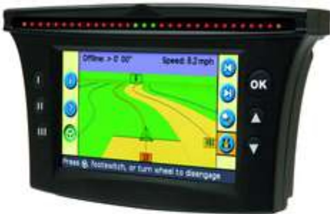
Рис. 5. Устройство параллельного вождения Trimble EZ-Guide 500
