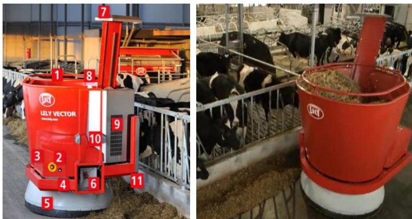
Рис. 4.13. Координатный смеситель-раздатчик системы кормления Vector: 1 – бункер; 2 – кнопка экстренной остановки; 3 – тензодатчик; 4 – бампер с датчиками препятствий; 5 – вращающийся конус для подталкивания кормов; 6 – разъем зарядного устройства; 7 – шибер; 8 – антенна связи; 9 – шит управления; 10 – ультразвуковой датчик для определения расстояния от ограждения кормового стола; 11 – лазерный датчик наличия корма на кормовом столе
