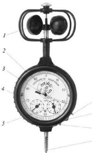
Рис. 5. Анемометр чашечный: 1 – четырехчашечная вертушка; 2 – циферблат; 3 – стрелка единиц; 4 – стрелка сотен; 5 – стрелка тысяч; 6 – ушки; 7 – арретир; 8 – винт для крепления анемометра
