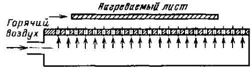
Рис. 9.3. Схема термообработки листовых изделий на «воздушной подушке»
