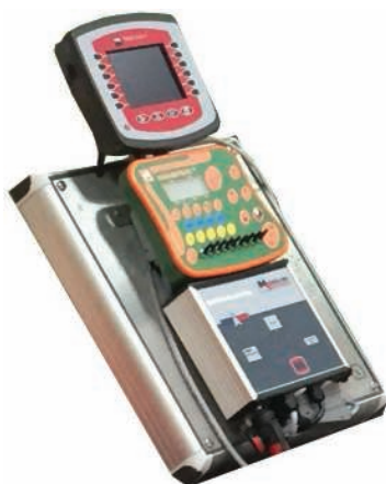
Рисунок 5.1 – Демонстрационный стенд для управления секциями опрыскивателя
