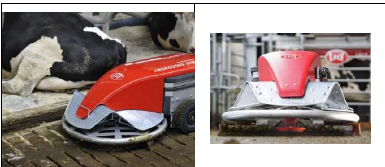
Рис. 7.8. Навозоуборочный робот Discovery
