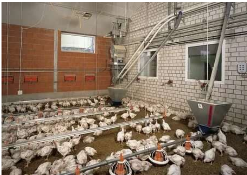
Рис. 5.8. Кормораздаточная система AugerMatic
