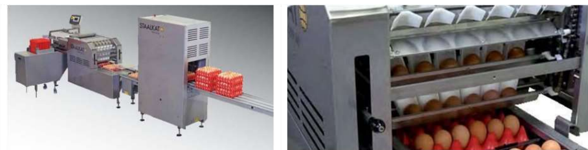
Рис. 5.18. Роботизированная машина упаковки пищевого яйца STAALKAT FARMPACKERS
