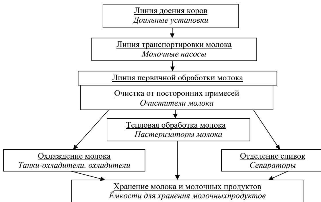
Рис. 4.2. Конструктивно-технологическая схема процесса производства молока и первичной обработки молока на молочной ферме
