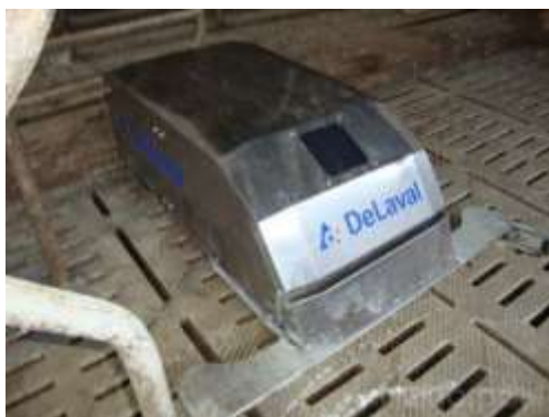
Рис. 7.6. Навозоуборочный робот RS250 фирмы «DeLaval»
