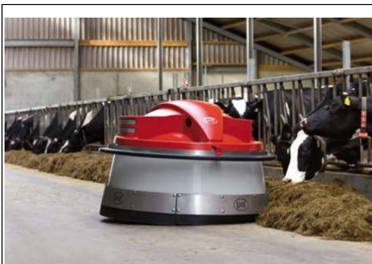
Рис. 3.20. Робот-подталкиватель кормов Juno фирмы «Lely»
