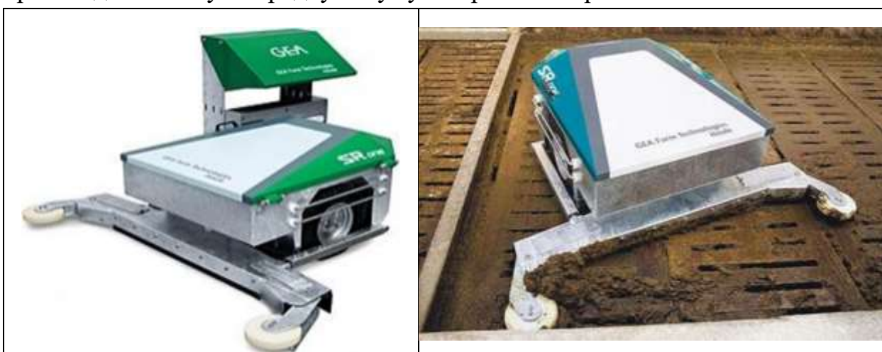
Рис. 7.5. Навозоуборочный робот Srone фирмы «GEA Farm Technologies»
