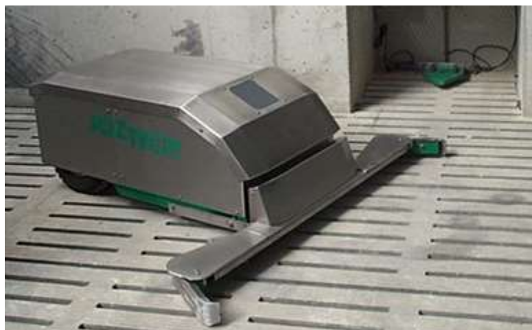
Рис. 7.7. Навозоуборочный робот JOZ-Tech фирмы «JOZ»
