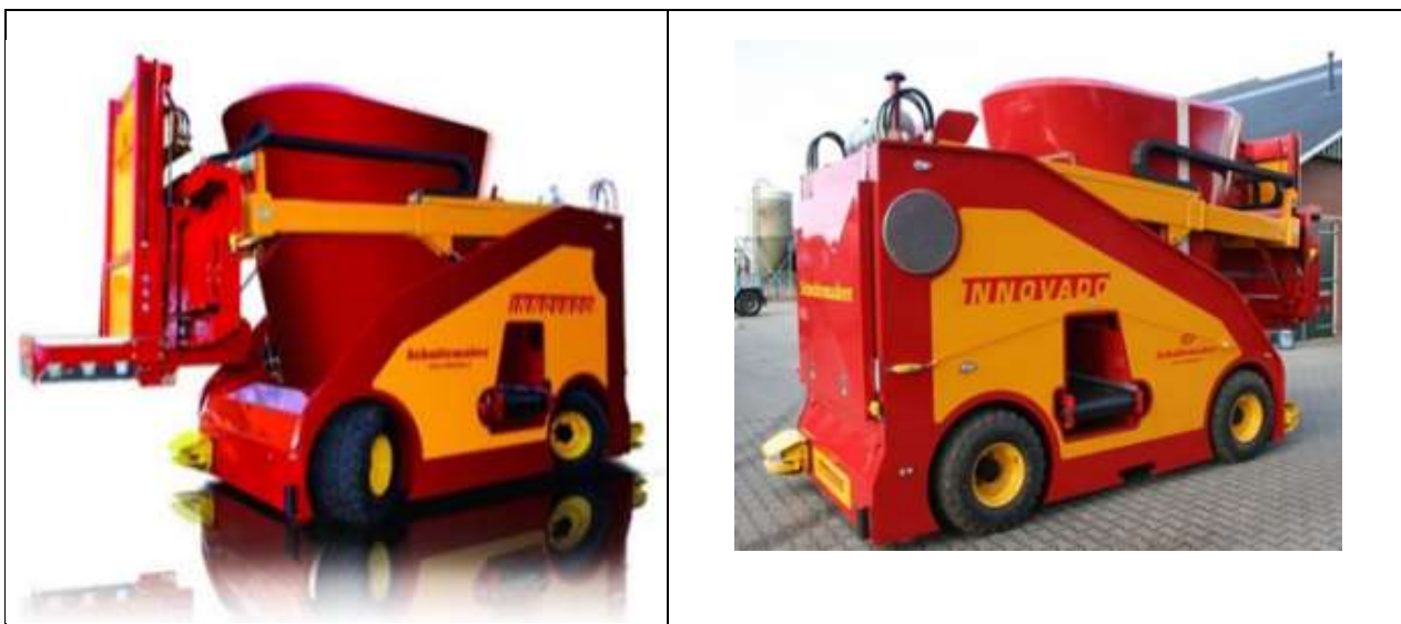
Рис. 3.15. Автоматический смеситель-кормораздатчик Innovado
