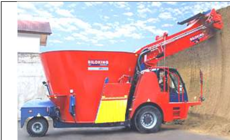
Рис. 3.8. Самоходный смеситель-кормораздатчик Siloking
