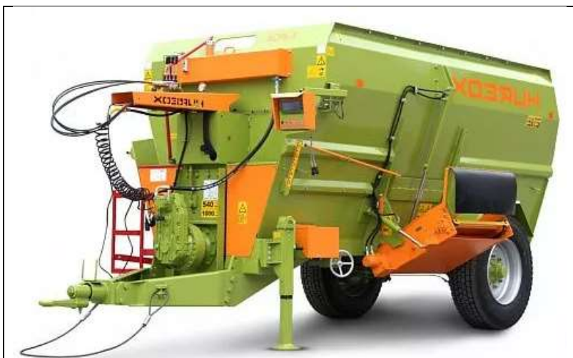
Рис. 3.6. Измельчитель-смеситель-раздатчик кормов ИСРК-12 «Хозяин»
