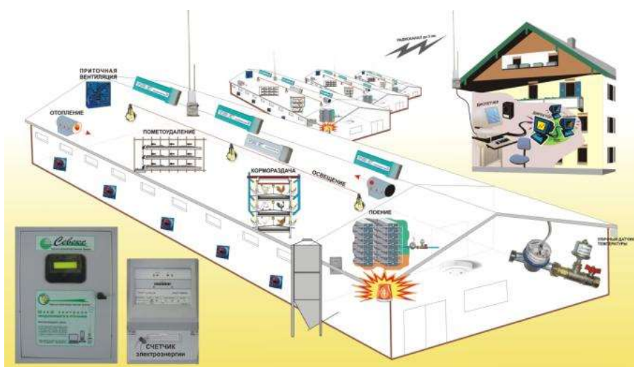
Рис.5.22. Система диспетчеризации птицефабрик НПФ «Севекс»
