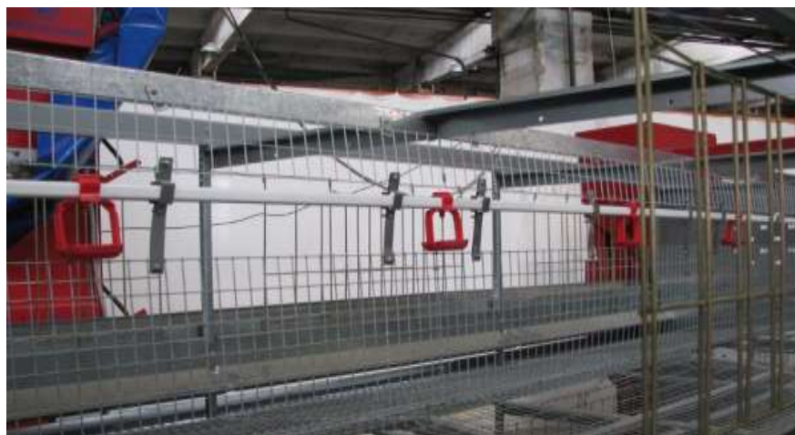
Рис. 5.3. Система поения кур несушек комплекта птицеводческого оборудования КПО-Н
