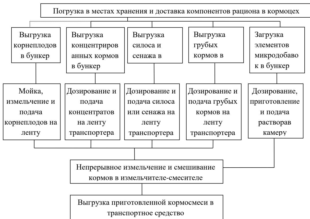
Рис. 2.1. Примерная технологическая схема кормоцеха
