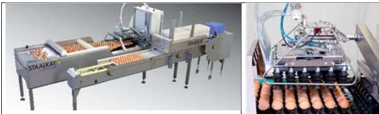
Рис. 5.19. Роботизированная машина упаковки инкубационного яйца STAALKAT HATCHERY PACKER
