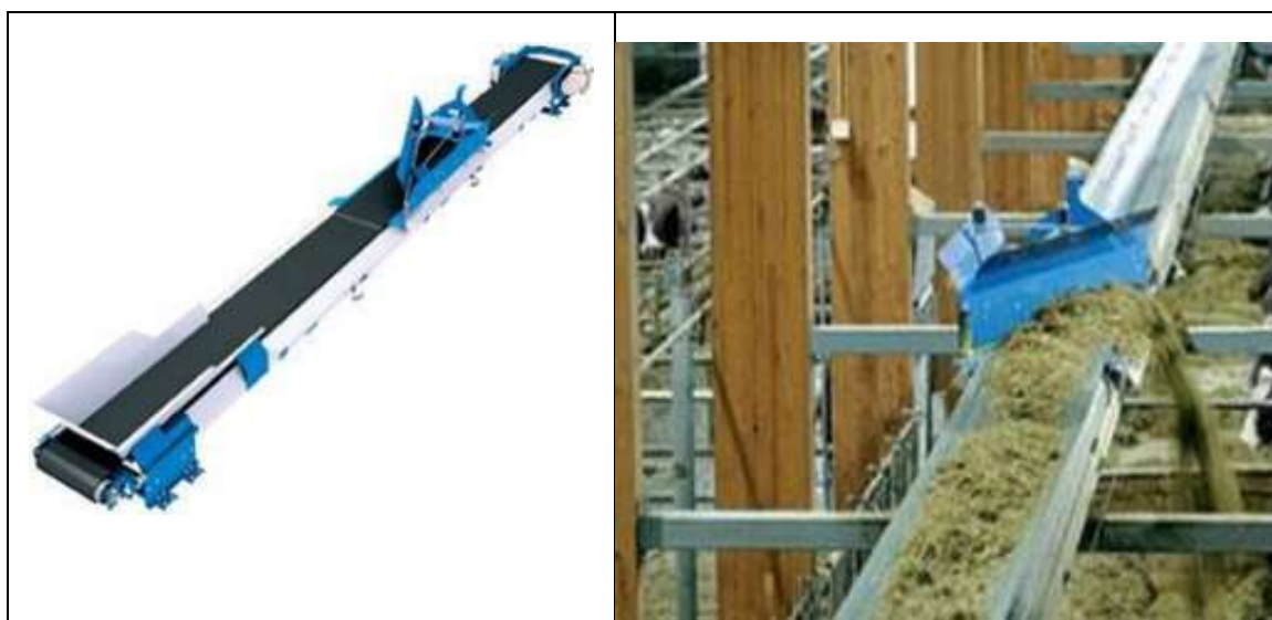
Рис. 3.2. Ленточный конвейер Pellon Belt Feeder
