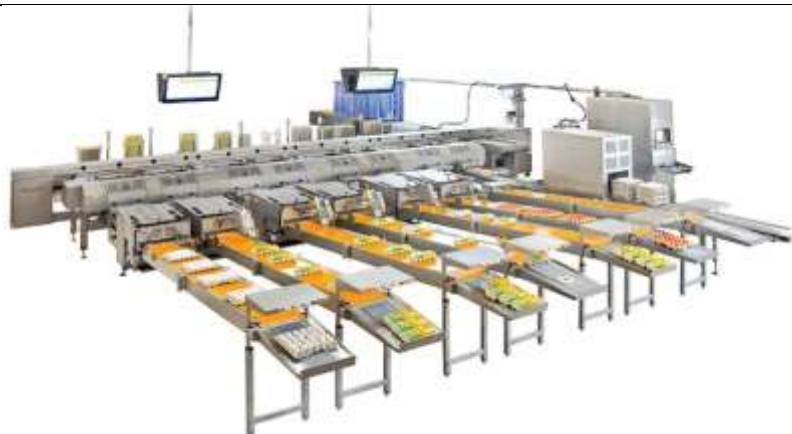
- роботизированная яйцесортировочная машина STAALKAT ALPHA
