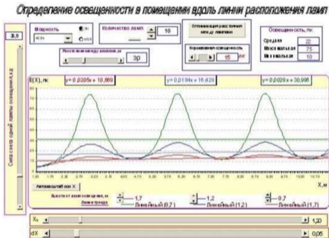
Рис. 6.5. Использование компьютеризированной модели для определения и оптимизации параметров систем освещения птичников
