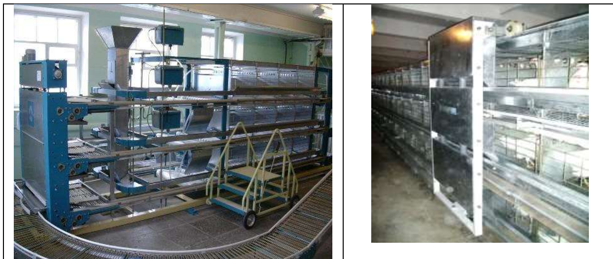
Рис. 5.1 Клеточная батарея для кур-несушек КБК – Н
