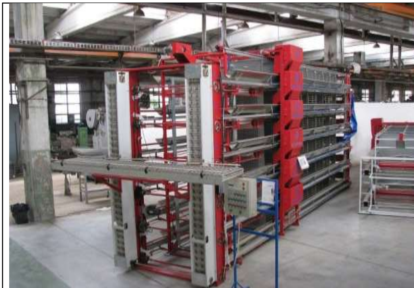
Рис. 5.6. Клеточная батарея для содержания промышленного стада кур-несушек КП-112ЛМ
