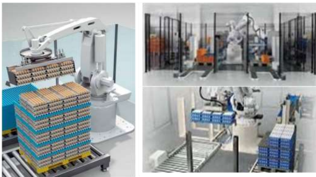
Рис. 5.20. Робот укладки лотков на паллеты ITALPROJECT OR P18
