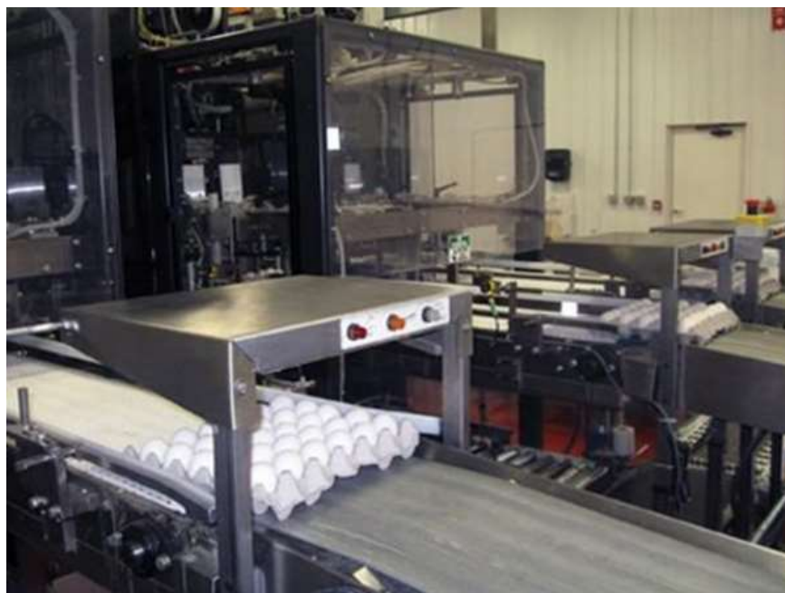
Рис. 5.21. Робот для упаковки яиц компании «Massman»
