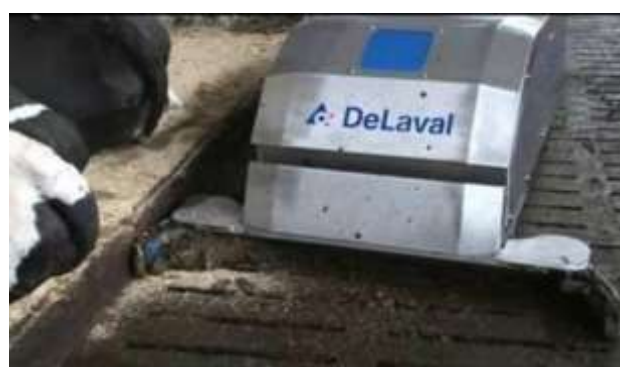
Рис. 7.6. Навозоуборочный робот RS250 фирмы «DeLaval»
