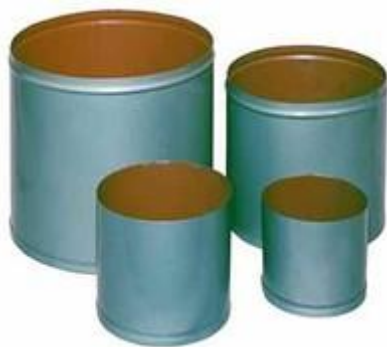
Рис. 1.3. Мерные сосуды емкостью 10, 5, 2 и 1 литр для определения насыпной плотности заполнителей
