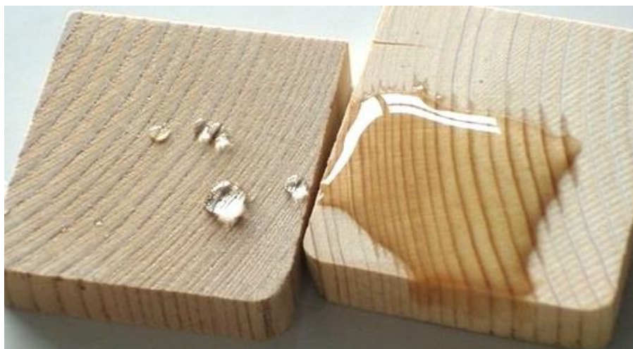
Рис. 1.6. Образцы гидрофобной (пропитанной гидрофобными составами) и гидрофильной (не обработанной) поверхности древесины
