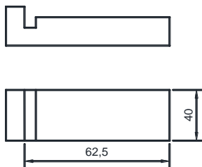
Рис. .4.17. Стальные пластинки для испытания на сжатие половинок балочек
