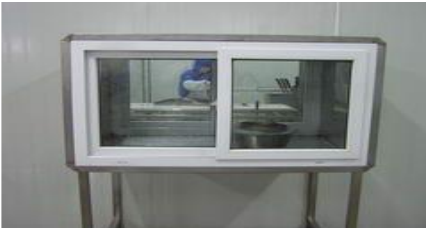
Рис. 25. Окно-бокс, через которое передают извлеченные ястыки из разделочного помещения в комнату переработки икры
