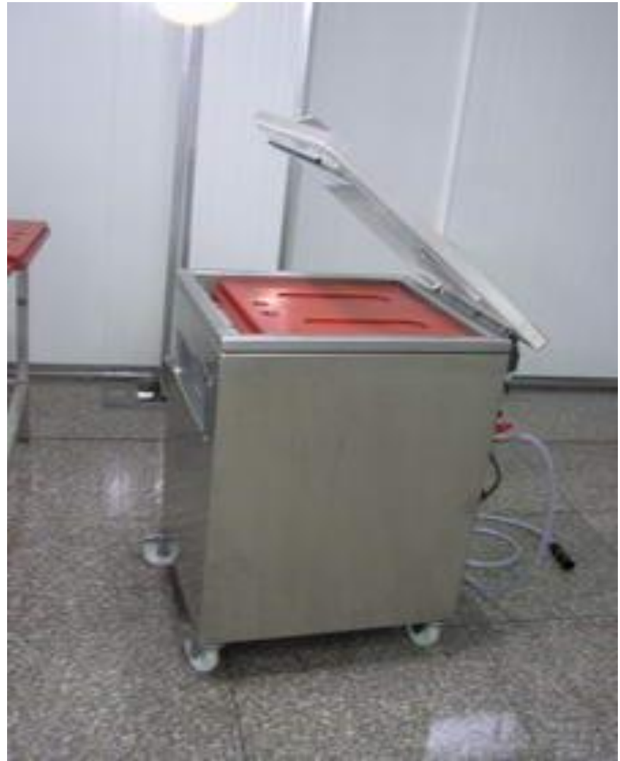
Рис. 38. Аппарат для вакуумного укупоривания банок. Съёмные трафареты (красного цвета) позволяют использовать банки различной емкости
