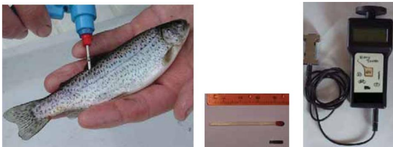
Рис. 3.1. Введение РІТ-метки в тело рыбы (слева); РІТ-метка в правом нижнем углу (в центре) и сканер (справа)
