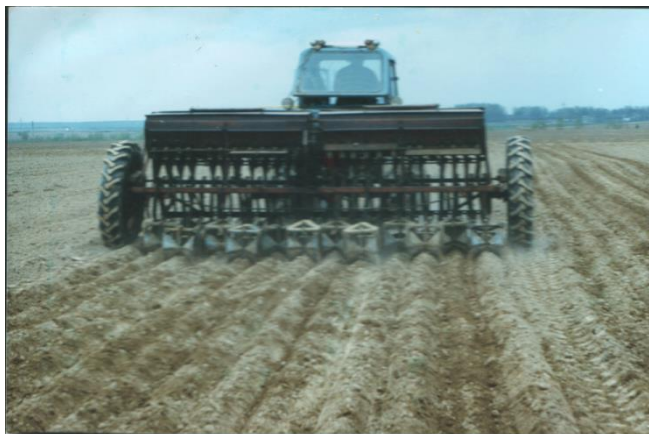
Фото 1. Микрорельефный посев с использованием сеялки СЗУ- 3.6
