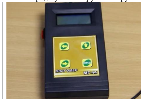
Рис. 7.7. Клавиши управления прибором МГ- 44
