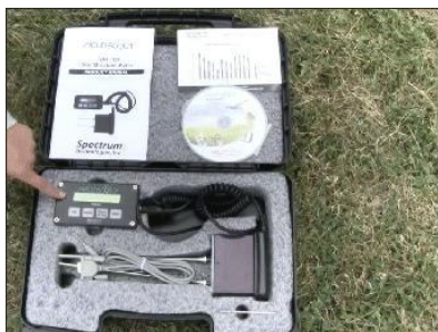
Рис. 7.5. Влагомер почв, песка и грунта TDR -100
