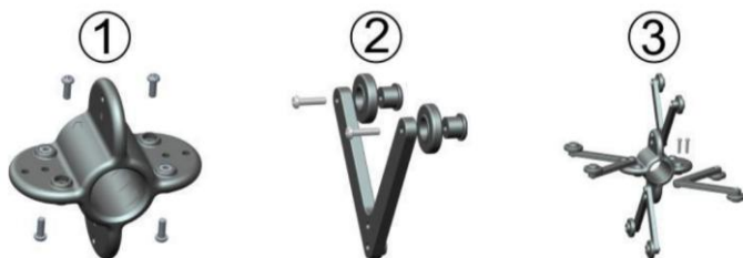
Рис. 11.6. Последовательность сборки и установки направляющих
