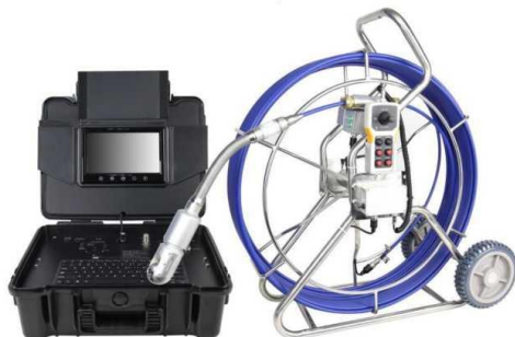
Рис. 11.1. Система телеинспекции трубопроводов WPS-716 GJN-C58PT
