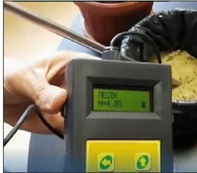
Рис. 3.12. Влажность песка, измеренная прибором МГ- 44
