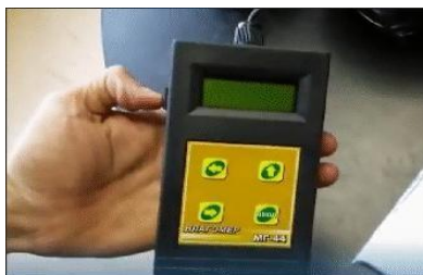
Рис. 7.8. Включение прибора МГ- 44
