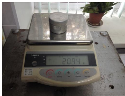
Рис. 7.2. Взвешивание пустого стаканчика и крышки для определения массы
