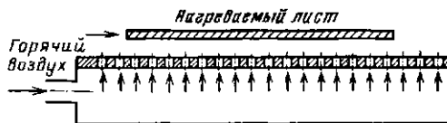
Рис. 9.3. Схема термообработки листовых изделий на «воздушной подушке»
