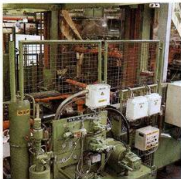
Рис. 3: Требуемое для процесса ускорения 460 л/мин. масло под давлением поставляет аккумуляторный блок, размещенный слева. Пластиновый насос типа V4, расположенный справа, заполняет аккумулятор во время "неподвижных" фаз. Справа размещается пропорциональный распределитель типа 4 WRZ 25.
