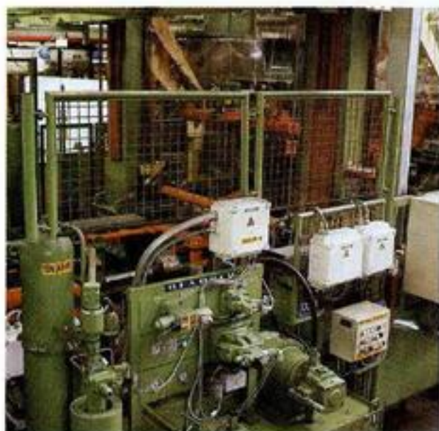
Требуемые для процесса ускорения 460 л/мин. поставляет аккумуляторный блок слева. Пластина насос V4, расположенный справа, заполнит аккумулятор в неподвижных фазах. Справа размещается пропорциональный распределитель 4WRZ 25.
