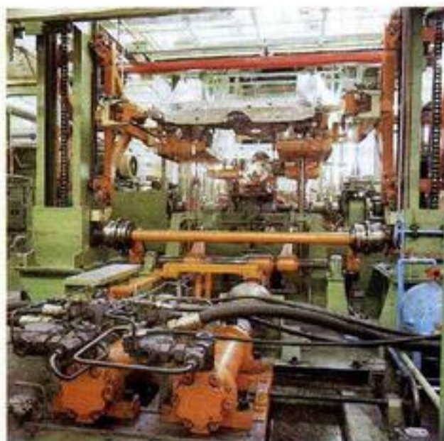
Рис. 2: Один цилиндр, второй цилиндр служит в качестве резервного цилиндра, приводит в действие посредством механических устройств одновременно все позиции.
