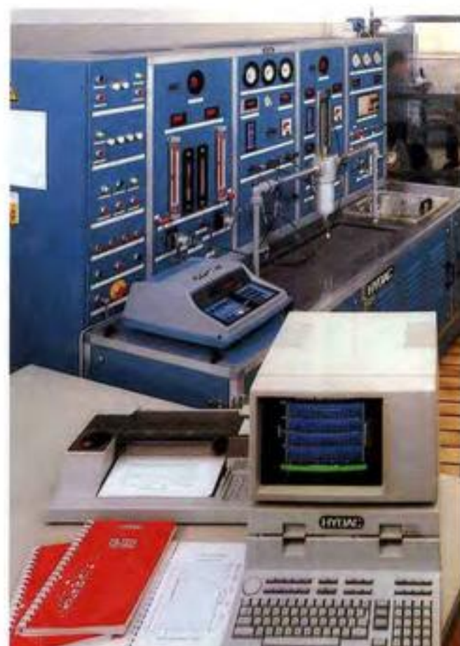
Рис. 7: Multipas - испытание согласно стандарту ISO 4572
