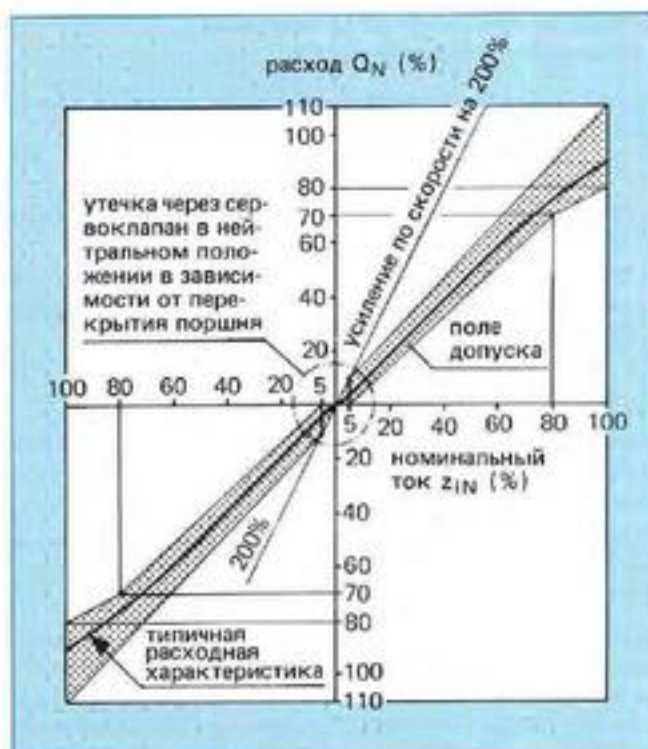
Рис. 13: Поле допуска расходной характеристики сервоклапана
