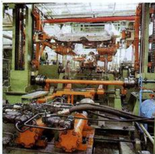
Один цилиндр, второй цилиндр служит в качестве резервного цилиндра, приводит в действие посредством механических устройств все 12 позиций одновременно.
