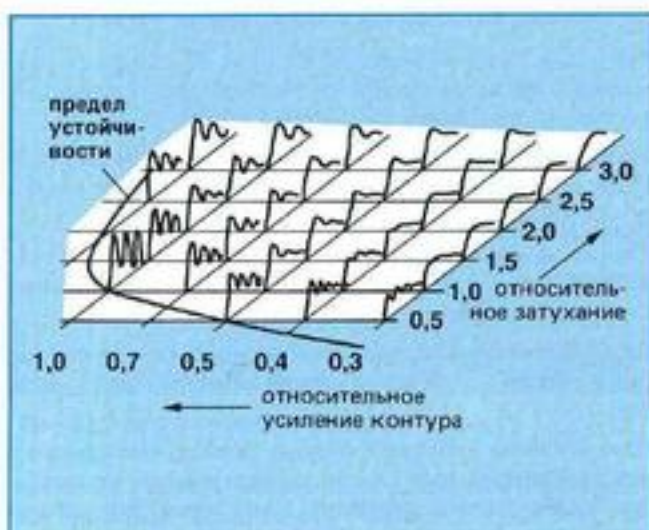
Рис. 4: Временная характеристика контура регулирования 3-го порядка
