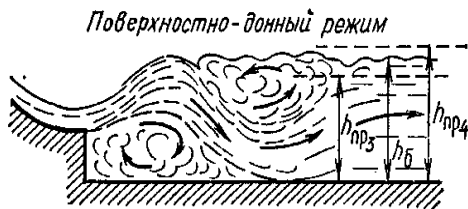
Рис. 5.8. Поверхностно-донный режим сопряжения потоков в НБ сооружения
