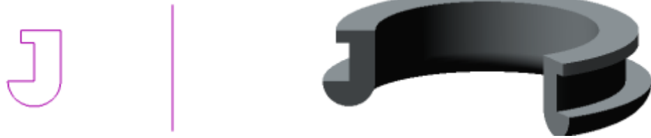
Рис. 6.5. Эскиз и элемент, образованный операцией вращения
