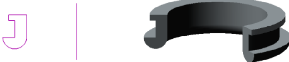
Рис. 5.23. Эскиз и элемент, образованный операцией вращения
