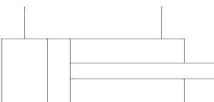
Гидроцилиндр двухстороннего действия с односторонним штоком
