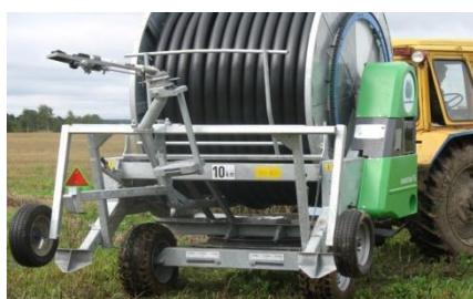
Рисунок 8.2. – Дождевальная машина (а) и внешний вид шлангового дождевателя (б)
