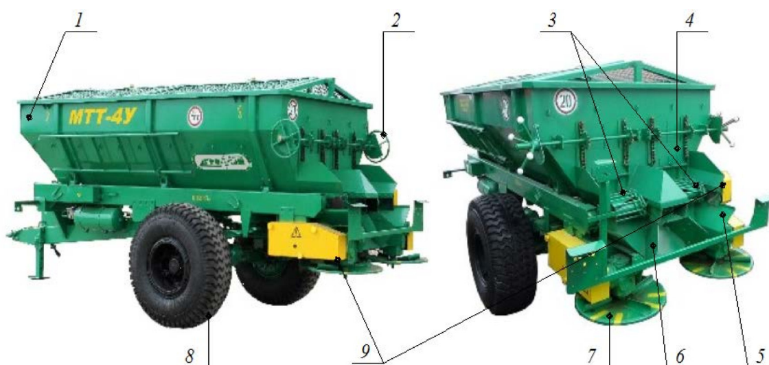
Рис. 11. Общий вид рассеивателя МТТ-4У: 1 – кузов; 2 – механизм регулировки дозирующих заслонок; 3 – подающий конвейер (транспортёр); 4 – дозирующая заслонка; 5 – лотку-туконаправитель; 6 – тукоделитель; 7 – разбрасывающий механизм; 8 – ходовое устройство; 9 – трансмиссия
