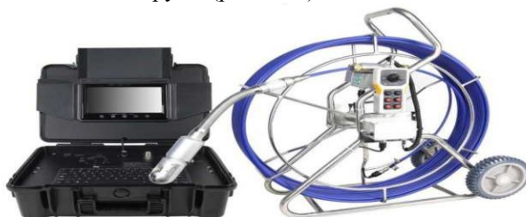
Рис. 22.1. Система телеинспекции трубопроводов WPS-716 GJN-C58PT
