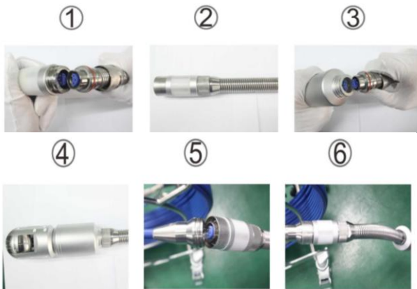
Рис. 22.5. Последовательность подключения видеокамеры 5. Передатчик привинтите к одному концу катушки и разъему. 6. Затяните передатчик и разъем.
