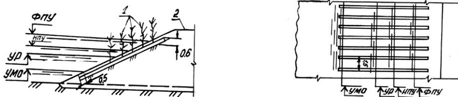
Рис. 3.11. Крепление откоса ивовыми хлыстами (временное покрытие не показано): УР – уровень растительности; 1 – поросль от ивовых хлыстов; 2 – гребень плотины (размеры в метрах)
