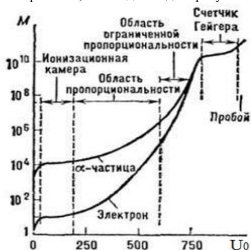
Рис. 28. Вольт-амперная характеристика газового разряда
