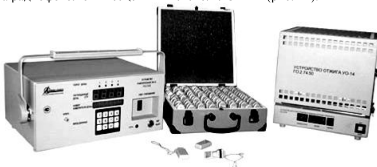
Рис. 14. Дозиметр гамма-излучения индивидуальный радиофотолуминесцентный ДГИ-14.
