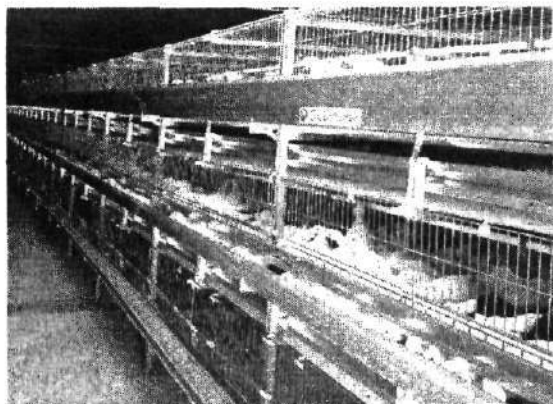
Рис. 9.2. Клеточная батарея Univent Starter с ленточным удалением помета
