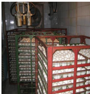
Рис. 147. Камера для аэрозольной обработки яиц формалином
