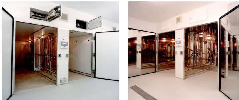
Рис. 62. Предварительный (слева) и выводной (справа) инкубаторы
