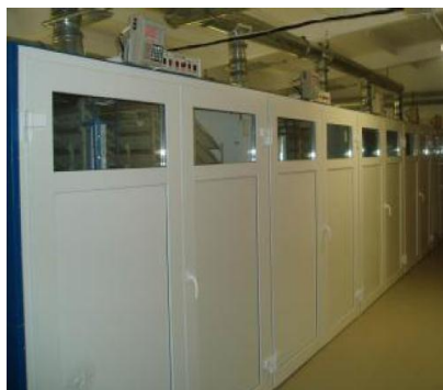
Рис. 46. Инкубатор предварительный ИП-36 «Эльбрус» (слева) и тележка с лотками (справа)
