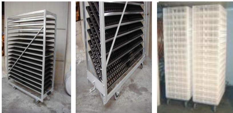
Рис. 61. Лотки и тележки, применяемые в инкубаторах ЕМКА-ПСМ
