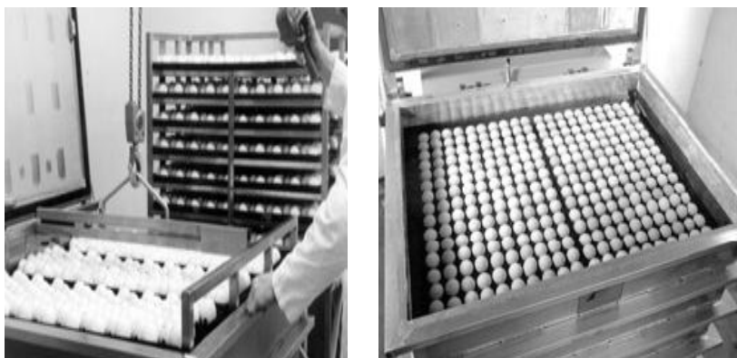
Рис. 149. Обработка инкубационных яиц методом прямого перепада давления
