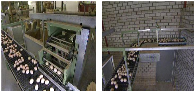
Рис. 81. Поперечный конвейер, идущий в яйцесборочный цех
