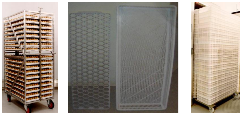
Рис. 64. Тележки и лотки предварительного и выводного шкафов
