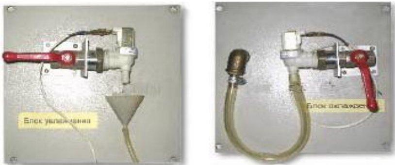
Рис. 45. Модернизация соленоидного клапана увлажнения (слева), охлаждения (справа)
